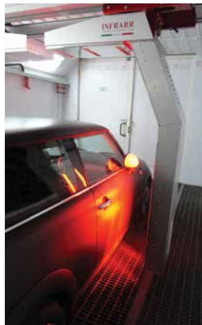
Esempio essiccazione della fiancata verticale utilizzando solo 6kW.
