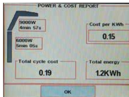
Schermata riassuntiva dell'energia utilizzata e dei costi. Summary screen of the energy used and the cost. Resumen de la energía utilizada y de los costes.
